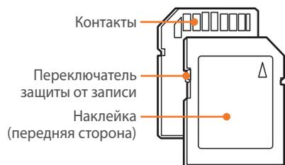
С помощью переключателя защиты от записи на карте SD, SDHC, SDXC или UHS-1 можно запретить удаление файлов. Сдвиньте переключатель вниз, чтобы установить защиту, или вверх, чтобы снять ее. Во время фото- и видеосъемки защита должна быть отключена.
