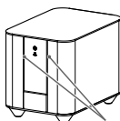
Ranhura de ventilação
