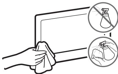
Не распыляйте воду или другие жидкости непосредственно на телевизор. Попавшая внутрь изделия жидкость может стать причиной повреждения, возгорания или поражения электрическим током.
