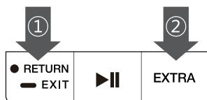
Если пульт Samsung Smart Control не сопряжен с телевизором, нажмите и удерживайте кнопки с нанесенными пометками ① и ② не менее 3 секунд для сопряжения пульта Samsung Smart Control с телевизором.
