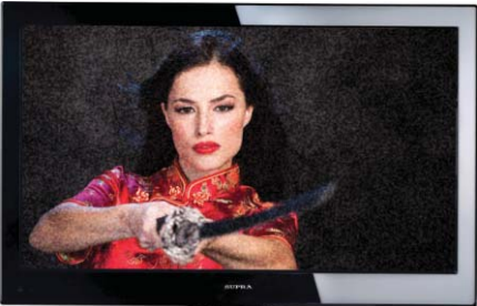
Изображение с «хлопьями». Обычно причина в слабом сигнале. Отрегулируйте антенну или поставьте усилитель антенны.
