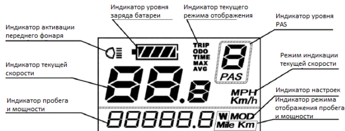
8-Сурет. LCD пульттағы дисплейінің құрылымы
