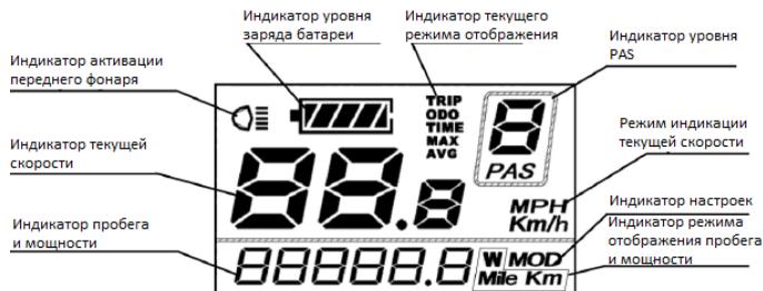
Рисунок 8. Структура дисплея LCD-пульта
