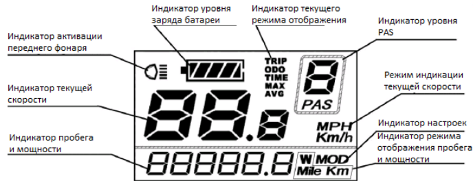
Малюнок 17. Структура дисплея LCD-пульта
