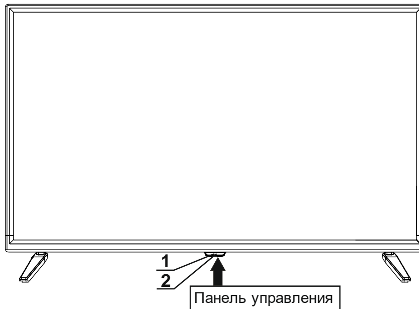
1 – окно фотоприемника; 2 – индикатор режимов работы телевизора. Рисунок 1
