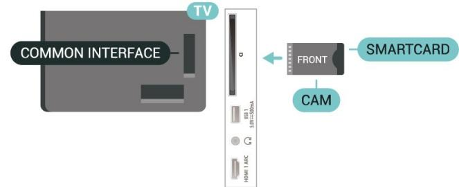
После включения телевизора до активации модуля CAM может пройти несколько минут. Если модуль CAM подключен, а подписка оплачена (возможны различные варианты подписки), вы можете смотреть зашифрованные каналы, которые поддерживаются смарт-картой CAM.
