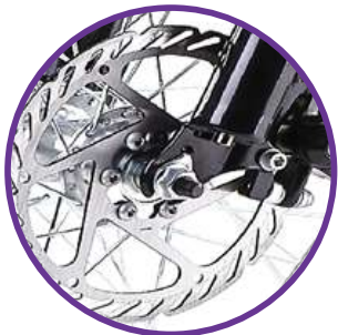
обычный дисковый тормоз
