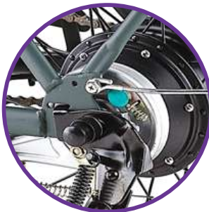
обычный барабанный тормоз
