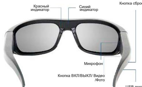
Цифровая камера (очки) X-TRY XTG44X предназначена для цифровой съемки в режиме «свободные руки», обладает возможностью формирования видеозображения путем записи последовательности цифровых кадров с разрешением до 3840x2160/30 кадров на встроенную память емкостью 128 ГБ ограниченной продолжительности, имеет встроенный микрофон. Внимательно прочитайте это руководство пользователя, чтобы повысить производительность и долговечность этого устройства. Использование очков с цифровой камерой:
