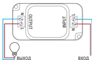
Модуль подключается в разрыв провода 220В, может работать при сниженном напряжении сети.
