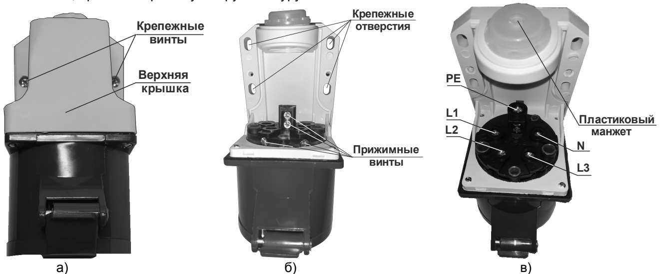
Рисунок 9 – Установка и подключение розеток
