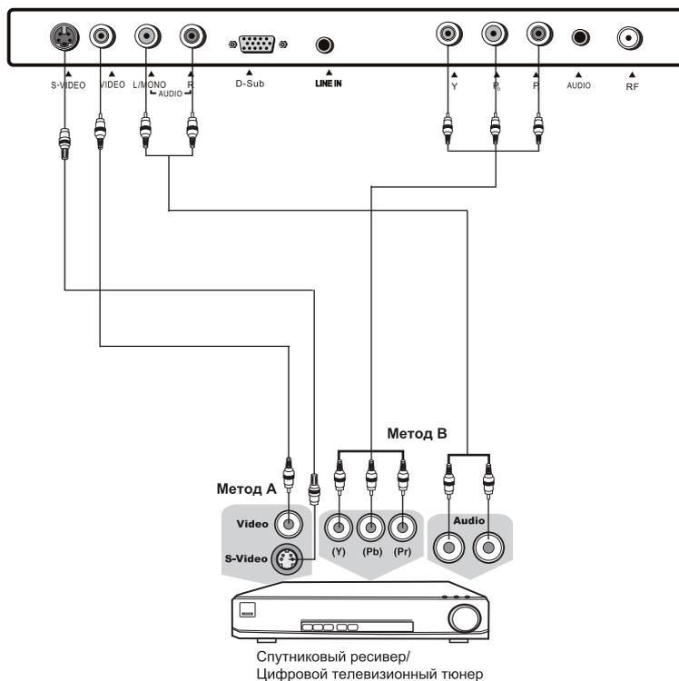
**Метод А.** Для подключения через композитные аудио- и видеоразъемы используйте прилагающиеся в комплекте кабели в соответствии с иллюстрацией.
