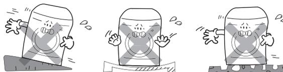
② Скорректируйте горизонтальность машинки с помощью регулируемых ножек.
