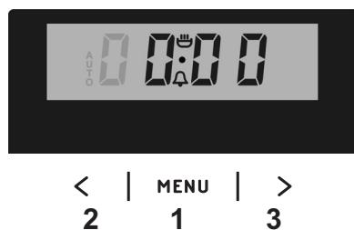
●установить нужное время работы минутного таймера при помощи сенсор 3 и 2.
