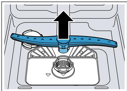
3. Под проточной водой проверьте выходные отверстия распылительных коромысел на отсутствие засорений и, если нужно, удалите посторонние предметы.
