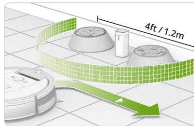
**Режим Halo:** Когда переключатель находится в нижнем положении (↓), устройство создает защитную зону, в которую Roomba не проникает. Это предотвращает столкновение Roomba с предметами, которые вы хотите защитить (например, собачьей миской или вазой), или входления в нежелательные зоны (например, в угол или под стол). Ограничитель Halo невидим и достигает примерно 60 см от центра устройства.
