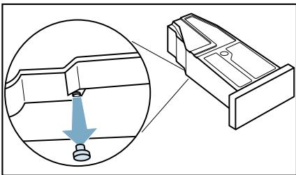
9. Снова поверните резервуар для конденсата на 180° и установите пробку в углубление на верхней стороне резервуара для конденсата.
