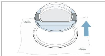
8. Поверните дверное кольцо на 180° и установите дверь соответствующим образом.
