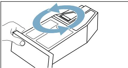
14. Задвиньте резервуар для конденсата до фиксации.
