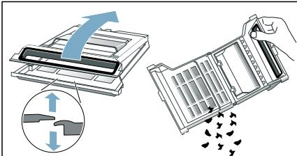
8. Тщательно промойте фильтр из контейнера для сбора ворса под проточной водой и просушите.
