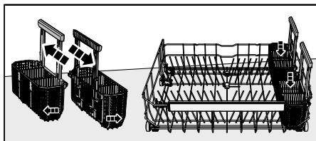
Корзина для столовых приборов регулируется и может разделяться на две части, которые можно прикреплять к боковой стороне нижней корзины.
