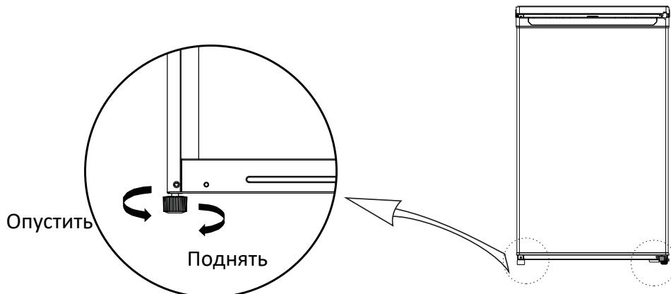
Если холодильник установлен не по уровню, дверь и магнитные уплотнители будут закрываться неплотно.
