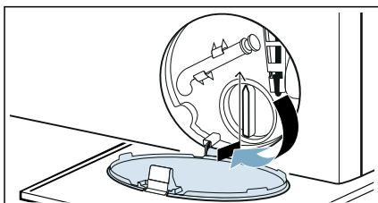
6. Закройте крышку отсека для сервисного обслуживания.
