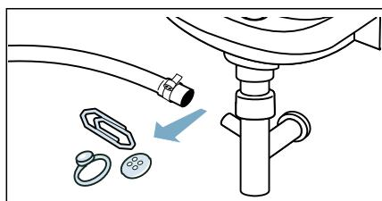
4. Снова подсоедините сливной шланг и закрепите место соединения с помощью шлангового зажима.
