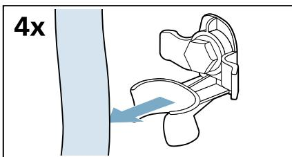
2. Отверните и снимите все винты четырёх транспортировочных креплений.
