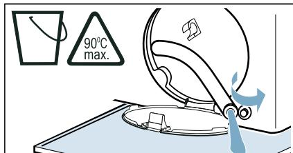
4. Осторожно отверните крышку насоса; остатки воды могут вытечь. Очистите внутреннюю часть, резьбу крышки насоса и корпус насоса. Крыльчатка откачивающего насоса должна свободно вращаться.
