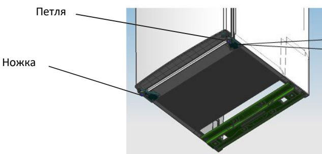
6. Отвинтите нижнюю петлю при помощи шестигранного ключа. Отвинтите регулировочную ножку с противоположной стороны.
