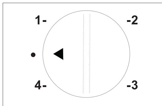
При помощи ручки можно установить температуру в морозильнике.
