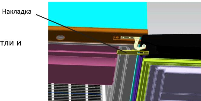
2. Снимите декоративную накладку верхней петли и заглушку на противоположной стороне двери.
