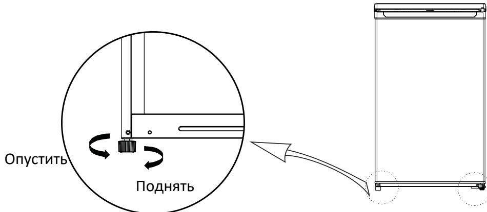
Если морозильник установлен не по уровню, дверь и магнитные уплотнители будут закрываться неплотно.
