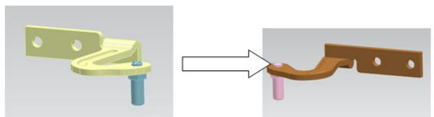
3. Снимите шарнир с верхней петли. Переверните верхнюю петлю и установите шарнир с другой ее стороны.
