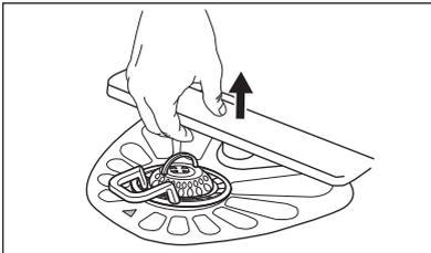
2. Промойте разбрызгиватель под струей воды. Для прочистки отверстий от частиц грязи воспользуйтесь заостренным предметом (например, зубочисткой).
