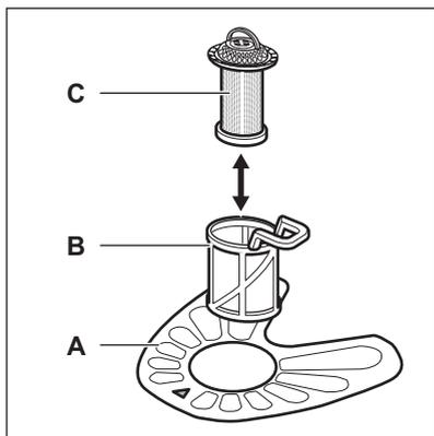
1. Поверните фильтр (В) против часовой стрелки и извлеките его.
