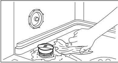
6. Чтобы закрыть емкость для соли, поверните крышку емкости для соли по часовой стрелке.
