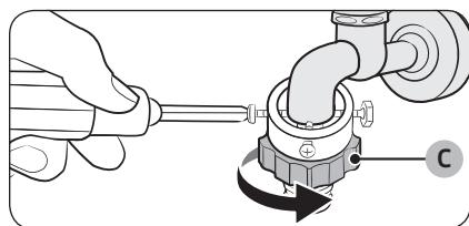
4. Наденьте адаптер на водопроводный кран и затяните винты, одновременно приподнимая адаптер.
