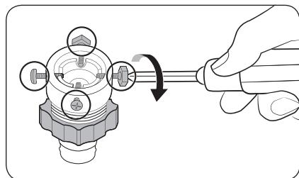
2. С помощью отвертки Phillips ослабьте четыре винта на адаптере.
