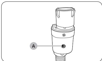
Шланг Aqua обеспечивает уведомление пользователей о риске утечки воды. Он обеспечивает измерение потока воды. При возникновении опасности утечки воды цвет индикатора (A) в центре изменяется на красный.
