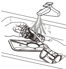
3 Большие остатки пищи смойте проточной водой, для очистки мелких используйте мягкую щетку.
