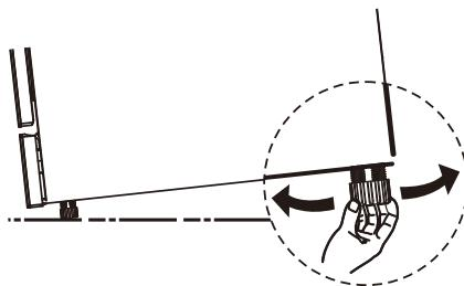
**ПРИМЕЧАНИЕ:** угол наклона прибора не должен превышать 2°.
