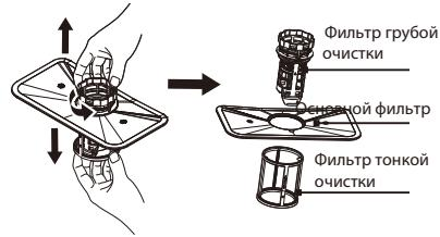
2 Снимите фильтр тонкой очистки, потянув его вниз. Отсоедините фильтр грубой очистки от основного фильтра, скжав его у основания.
