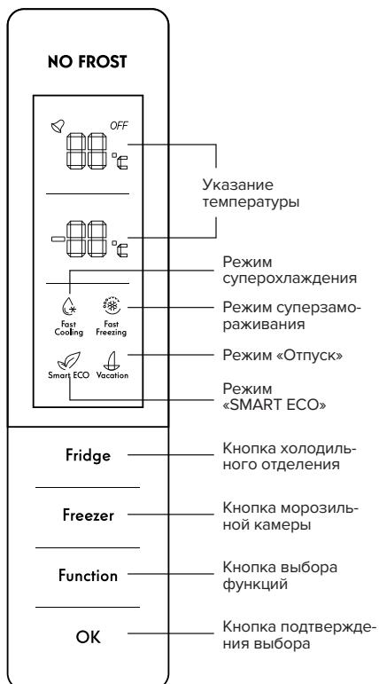
Когда холодильник подключается к источнику питания впервые, все иконки на панели дисплея загораются на 2 секунды. Когда все двери закрыты, дисплей автоматически гаснет, если не нажимать кнопки в течение 3 минут. Дисплей загорается при открытии любой двери или нажатии любой из кнопок управления.
