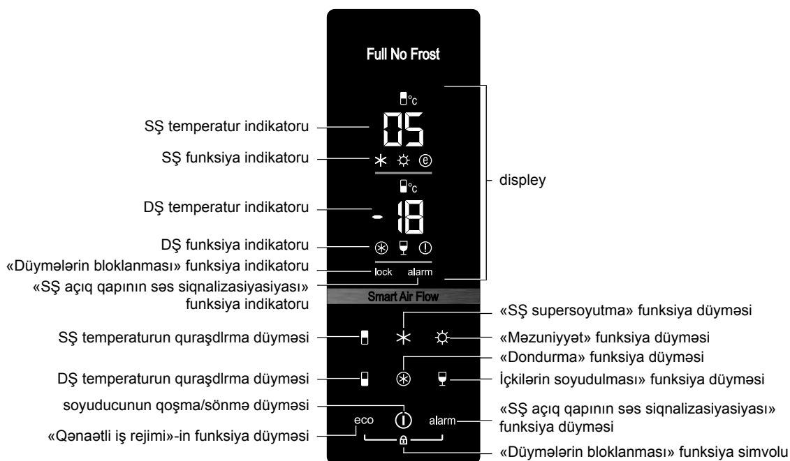
Şəkil 3 – İdarəetmə bloku
