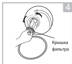
Откройте крышку фильтра, повернув против часовой стрелки
