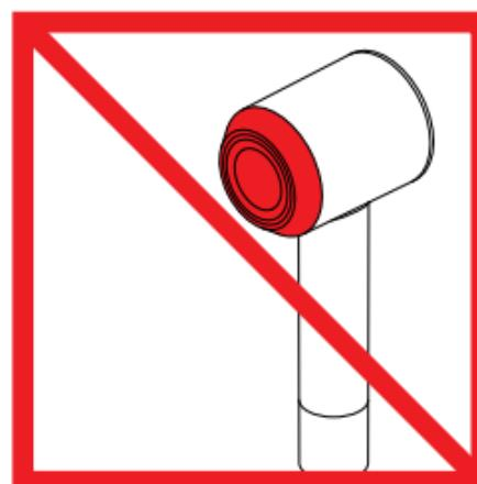
Выпускное отверстие, металлическое кольцо, насадки и зона, помеченная красным, могут сильно нагреваться в процессе использования. Дайте им остить, прежде чем прикоснуться.
