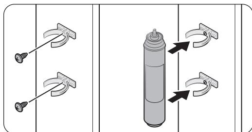
1. Прикрепите **зажимы для блокирования** (x2) в соответствующие места под раковиной, например. После чего, зафиксируйте **зажимы для блокирования** с помощью шурупов.
