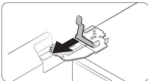
4. Потяните зажим, чтобы снять его.
