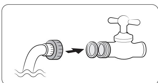
1. Подсоедините трубку для воды с помощью муфты
