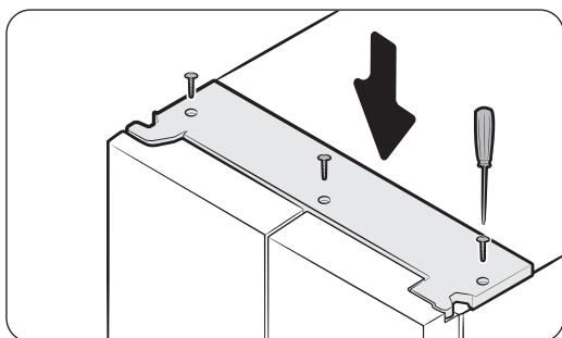
6. Установите крышку петли, начиная с передней части, а затем затяните винты. Используйте крестовую отвертку для этого действия.
