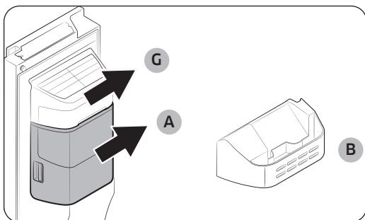
Если вы не используете льдогенератор, и вам требуется больше места для хранения, извлеките съемное **ведерко льдогенератора (A)** и снимите крышку (G). После чего, вставьте **индикатор Морозильной камеры (выборочно) (B)** на место ведерка льдогенератора.
