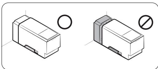
3. Повторно вставьте резервуар воды, чтобы он подходил к механизму диспенсера. Убедитесь в том, что его передняя часть (с передней крышкой) резервуара находится спереди.
