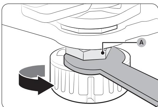
2. С помощью гаечного ключа 19 мм (не предоставлен), поверните **гайку зажима (A)** в направлении движения часовой стрелки, чтобы ее ослабить.
