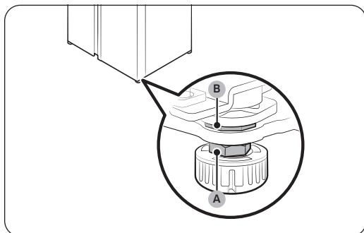
1. Откройте дверцу, чтобы отрегулировать и закрутить две гайки (A) и (B) на передней нижней части дверцы.
