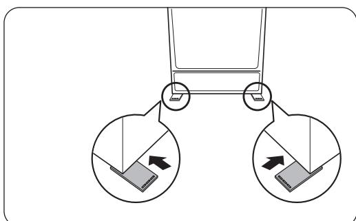
Если вам необходимо поднять заднюю часть холодильника, чтобы выровнять его, вы можете воспользоваться регулировочными пластинами в комплекте. Следуйте этим инструкциям, чтобы поднять заднюю часть холодильника.
