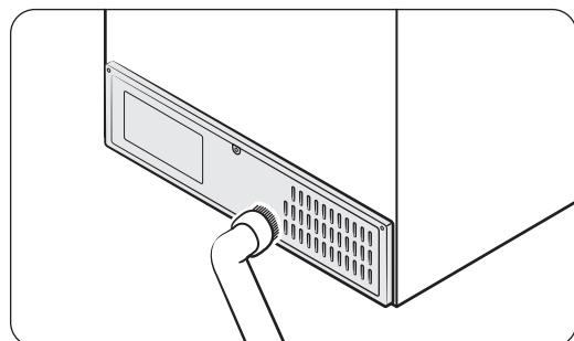
Удерживая и поворачивая конец дозатора крана, потяните его вниз, чтобы снять. Очистите и соберите заново.
