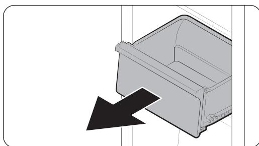
Слегка приподнимите спереди выдвижной ящик и извлеките его.
