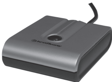
Рис. 2.10. Приемник для связи с беспроводными устройствами
