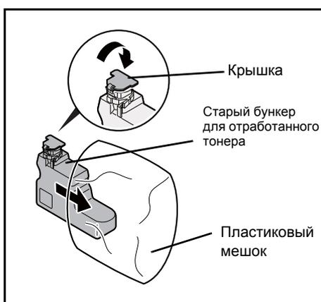
**3** Вынув бункер из принтера, закройте его откидную крышку.
