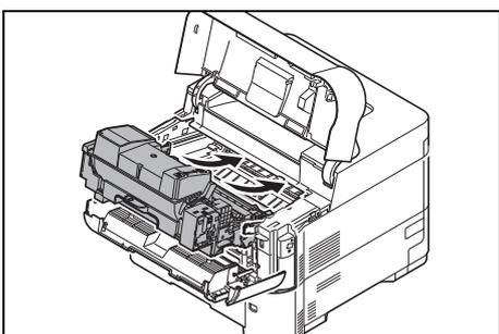
**4** Установите в аппарат узел проявки и картридж с тонером на место.
