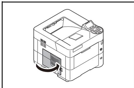
**7** Убедитесь, что бункер отработанного тонера установлен правильно, и закройте левую крышку.
