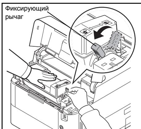
**2** Поверните фиксирующий рычаг в положение разблокировки.
