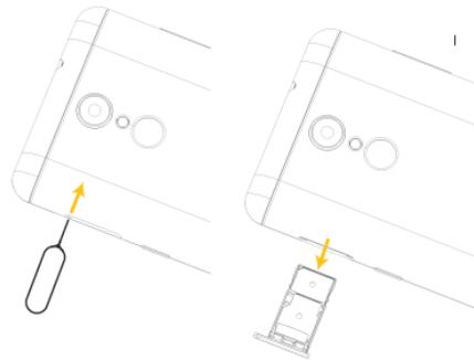
2. Установите SIM-карту(ы) в разъем SIM1 и (или) SIM2, как показано на рисунке и установите держатель SIM/microSD-карт в смартфон.
