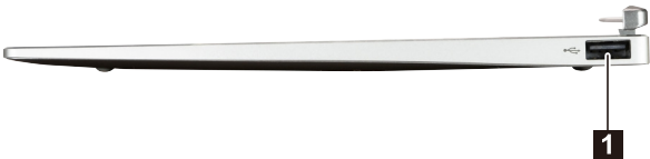
1 Порт USB 2.0 Позволяет подключать устройства USB.
