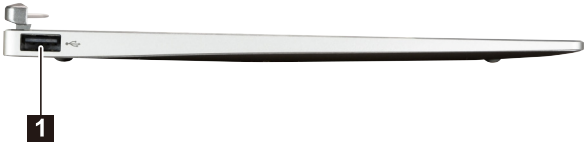
1 Порт USB 2.0 Позволяет подключать устройства USB.
