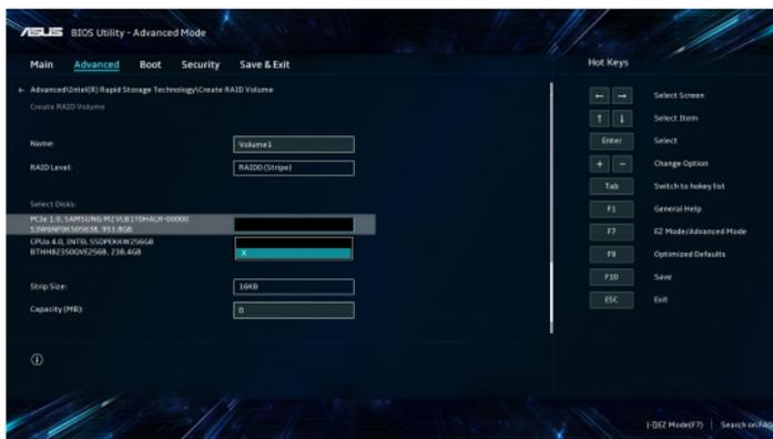
8. Выберите пункт **Strip Size**, нажмите <Enter> для выбора размера блока данных для массива RAID и нажмите <Enter>. Размер блока данных находится в диапазоне от 4 КБ до 128 КБ.
