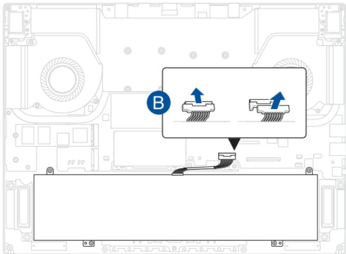
Для подключения аккумулятора совместите и подсоедините кабель к разъему аккумулятора, затем закройте крышку отсека.
