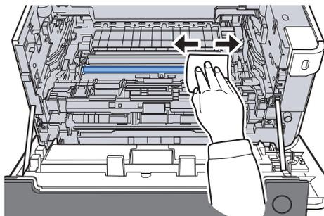
**7** Чтобы очистить кабель наполнителя, переместите устройство для очистки основного наполнителя на барабанном блоке вперед-назад 2—3 раза.
