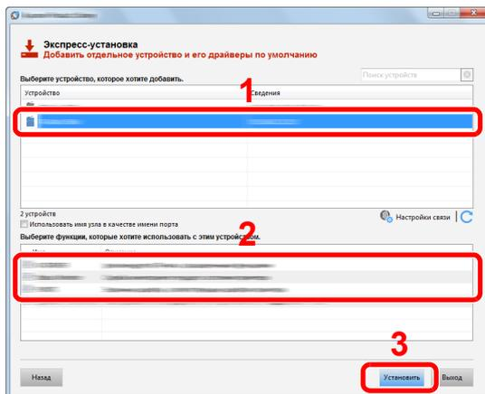
Также можно выбрать параметр [Использовать имя узла в качестве имени порта] и задать его для использования имени хоста стандартного порта TCP/IP. (Нельзя использовать USB-подключение.)
