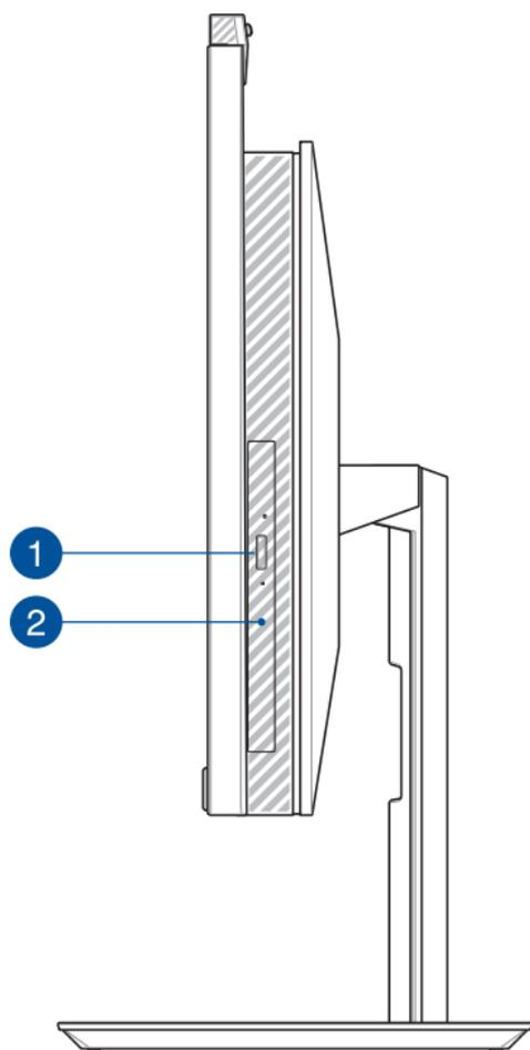
**1****Кнопка извлечения оптического диска
