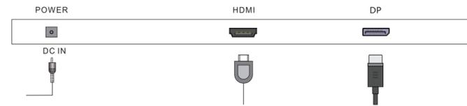
Для защиты оборудования следует всегда отключать ПК и ЖК-монитор перед подключением кабелей.
