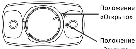
1. Поверните стрелку на крышке батарейного блока против часовой стрелки из закрытого положения в открытое. Откройте батарейный блок.
