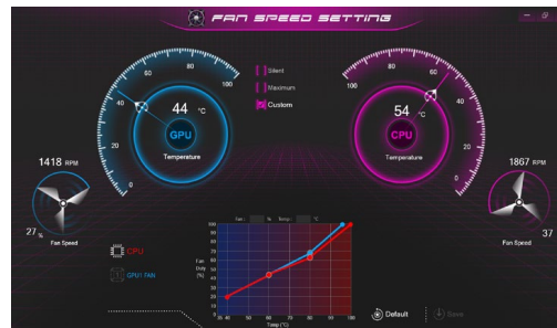
Figura 8 - Control de velocidad de FAN
