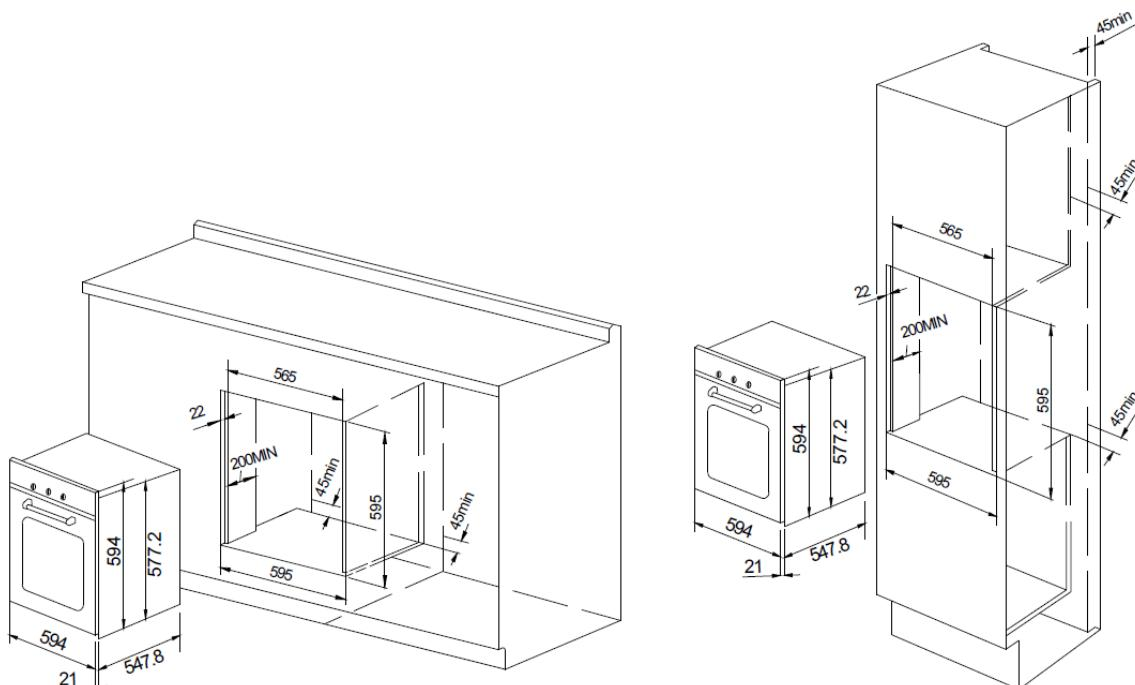
Для обеспечения соответствующего требованиям уровня вентиляции необходимо снять заднюю панель шкафа, в который устанавливается прибор. Лучше всего прибор устанавливать на два деревянных блока. Если же установка производится на плоскую поверхность, то в целях вентиляции необходимо оставить зазор  $45 \times 560$  мм.
