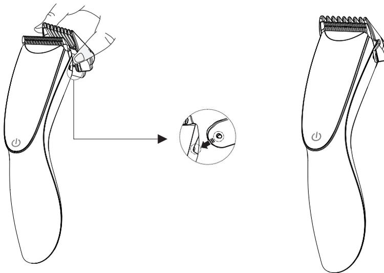
Также вы можете установить необходимую длину стрижки волос от 0,8 мм до 2,8 мм регулятором длины стрижки у лезвий. Для регулировки длины нажмите кнопку на регуляторе и передвиньте его вверх или вниз.
