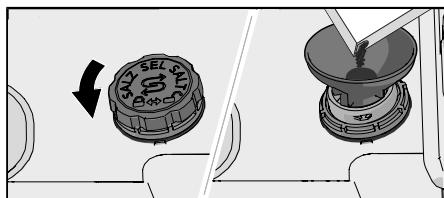
1. Снимите крышку отделения для соли, повернув ее против часовой стрелки.
