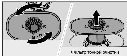
1. Поверните стопорное кольцо против часовой стрелки и поднимите фильтр тонкой очистки вверх.
