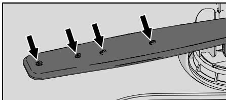
Чтобы облегчить очистку, можно снять разбрзгиватели. Не забудьте надежно установить их обратно после очистки.
