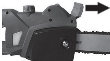
Рис. 8 Включение тормоза цепи
