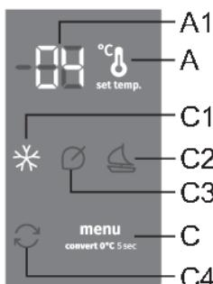
При следующем нажатии на кнопку **A** отобразится максимальное значение, которого достигла температура в холодильном отделении.
