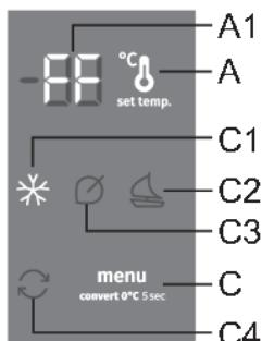
**Включение.** Чтобы включить функцию «Быстрое замораживание», нажмите кнопку **C**, пока на дисплее не загорится **C1**. На дисплее отобразится **FF**.
