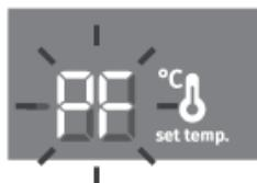
При отключении электроэнергии температура внутри прибора может превысить допустимый уровень. В этом случае после возобновления электроснабжения включится сигнализация о превышении допустимой температуры. Раздается звуковой сигнал, и на дисплее начнет мигать индикация **PF**.
