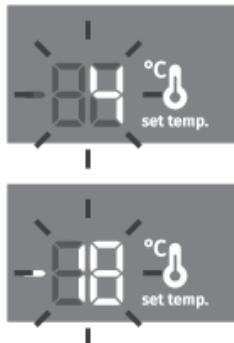
При превышении допустимой температуры в приборе включается прерывистый звуковой сигнал и на дисплее мигает значение заданной температуры отделения, в котором превышена температура.
