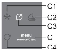
**Включение.** Чтобы включить режим **Eco**, нажмите кнопку **C**, пока на дисплее не загорится **C3**.
