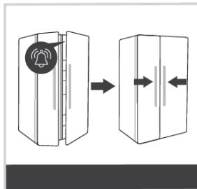
Если дверца холодильного или морозильного отделения открыта долго, включается повторяющийся звуковой сигнал и на дисплее начинает мигать индикатор **B1** или **B2** в зависимости от того, какая дверца открыта. Если не выключить звуковой сигнал, он будет раздаваться каждые 30 секунд.
