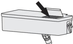
Откройте крышку и налейте воду. После наполнения резервуара водой закройте крышку.
