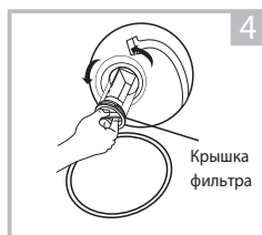
Откройте крышку фильтра, повернув против часовой стрелки
