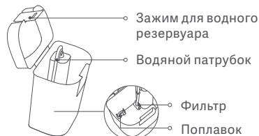
Резервуар для чистой воды
