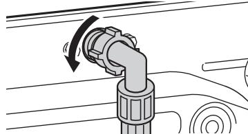
**2** Извлеките впускной фильтр подачи воды с помощью небольших щипцов и очистите
