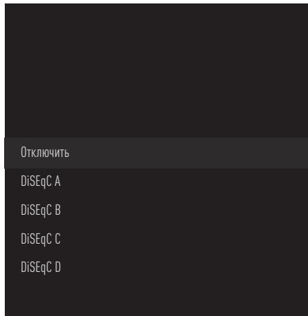
Выберите »DiSEqC A«, »DiSEqC B«, »DiSEqC C« или »DiSEqC D«, чтобы выбрать спутник в соответствии с положением DiSEqC в спутниковой системе.
