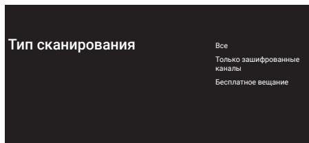
45 Чтобы выбрать сканирование только бесплатных цифровых каналов (бесплатные) или только зашифрованных цифровых каналов (зашифрованные) или то и другое (бесплатные+зашифрованные), нажмите »▼« или »▲« и выберите »Все«, »Только зашифрованные каналы« или »Бесплатные« и нажмите »●« для подтверждения.
