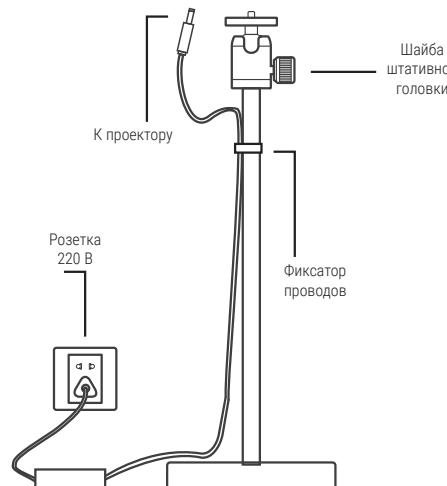
Отрегулируйте положение/наклон проектора и зафиксируйте штативную головку, вращая её шайбу по часовой стрелке.
