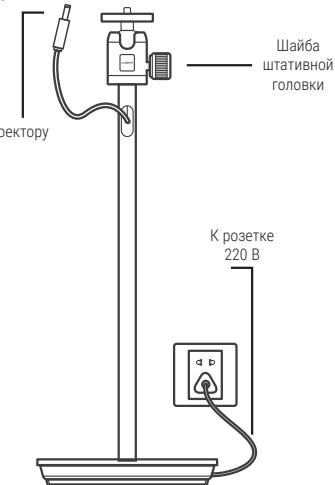
Отрегулируйте положение/наклон проектора и зафиксируйте штативную головку, вращая её шайбу по часовой стрелке.
