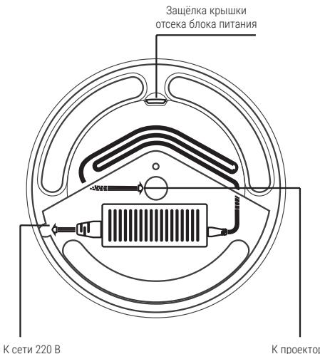
Разместите в отсеке блок питания и кабели согласно схеме выше. Используйте удлинитель кабеля питания в случае необходимости.
